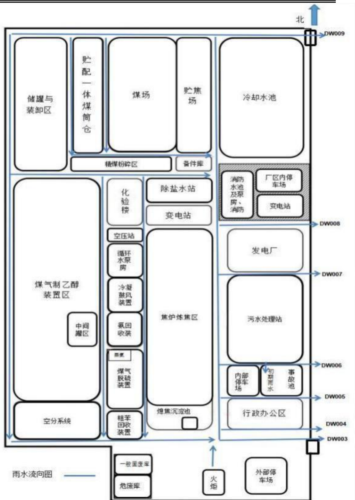
图4.2-4 厂区雨水收集管网示意图
